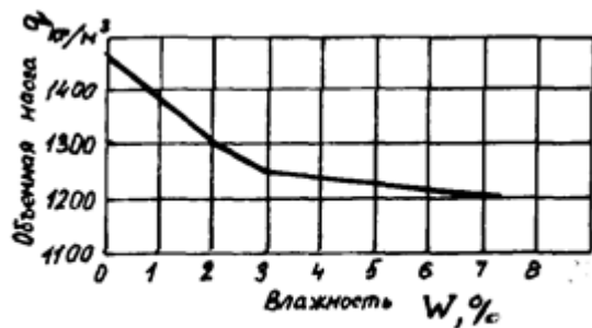
Изменение объемной массы \rho однородного порошкообразного материала в зависимости от влажности W
